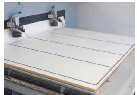
! Auf der Nesting-CNC werden die Platten komplett inkl. Fräsungen für die Fixchip-Verbinder bearbeitet.
