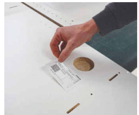
! Jedes Teil wird im Anschluss an die Nestingbearbeitung mit einem Etikett versehen.
