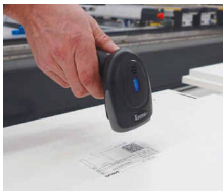
/ Durch Scannen des Etiketts wird das Bearbeitungsprogramm für die Profit H350 aufgerufen.
