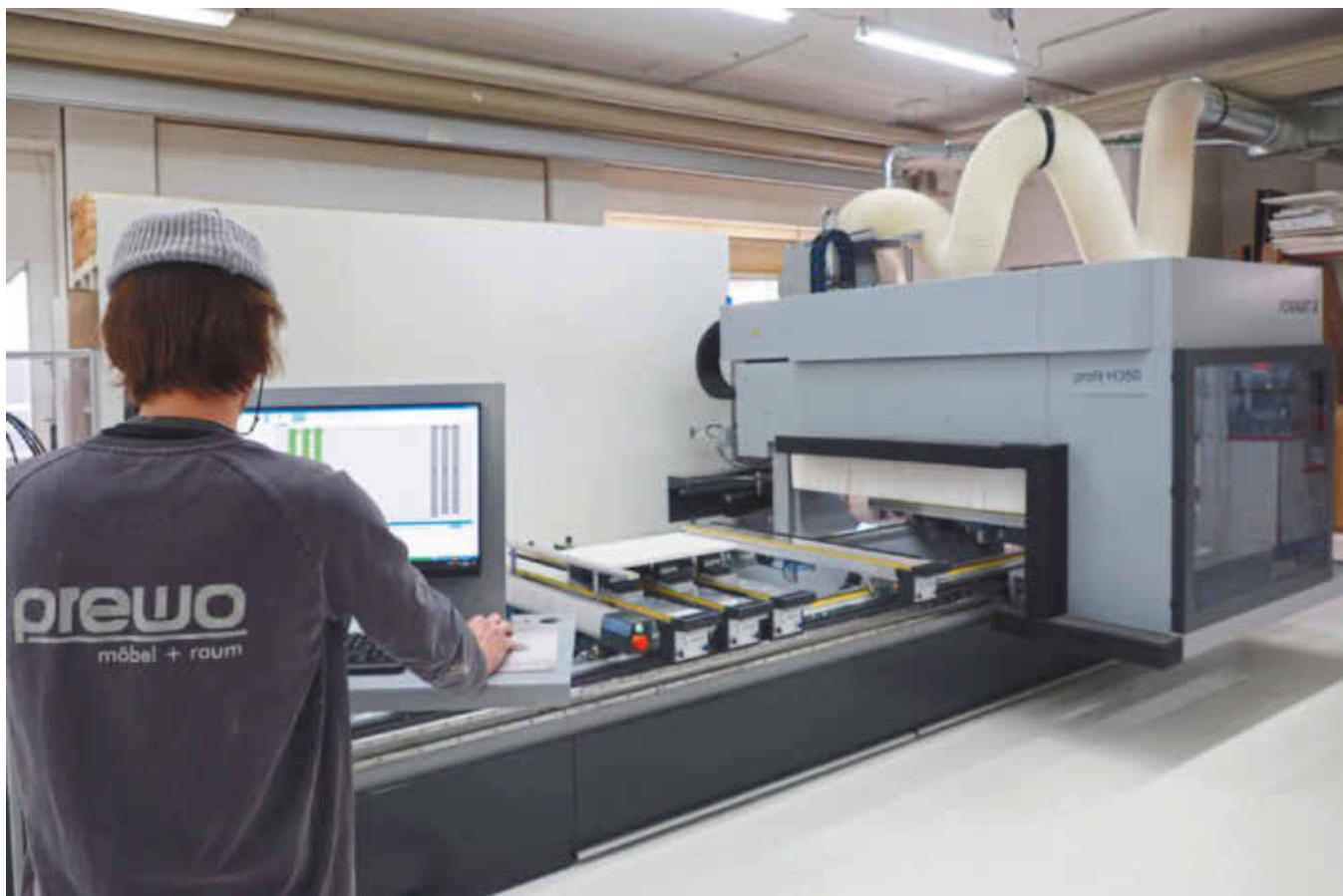
/ Seit Herbst 2024 hat Prewo eine neue 5-Achs-CNC vom Typ Format4 Profit H350 im Einsatz. „Die Maschine ist nicht nur für sich sehr cool, sondern sie erweitert auch ganz erheblich unsere Bearbeitungsmöglichkeiten“, kommentiert und freut sich Miriam Prewo.
