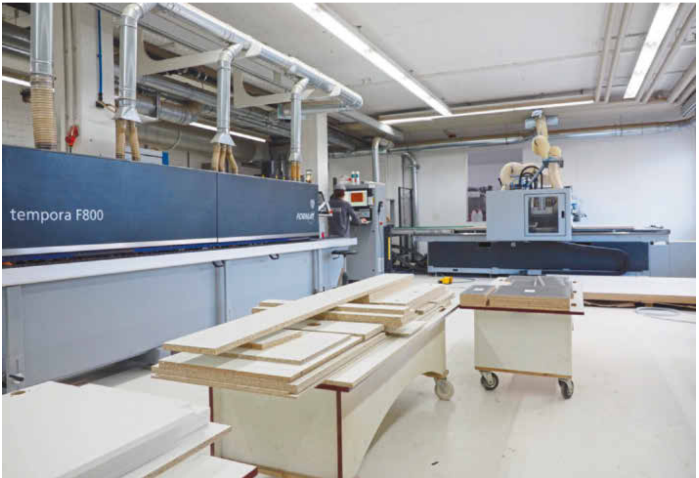
! Vor rund drei Jahren hat Prewo in eine Nesting-CNC vom Typ Format4 Profit H80 (hinten) und eine Kantenanleimmaschine Format4 Tempora F800 investiert. Die F800 ermöglicht mit ihrem Verleimaggregat AdvantEdge eine Nullfugenoptik für co-extrudierte Kanten.
